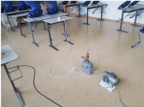
Nach dem Unterrichtsbetrieb erfolgt eine Luftkeimzahlbestimmung als aktives Impingement direkt auf den Nährböden. Dazu wird ein spezieller Keimsammler verwendet. Dieser besteht aus einer nach innen gerichteten Düse, durch welche die Luft bei Anlegen eines Vakuums hindurch gesogen wird. Dabei wird die Luft durch eine Lochmatrix gleichmäßig verteilt.
